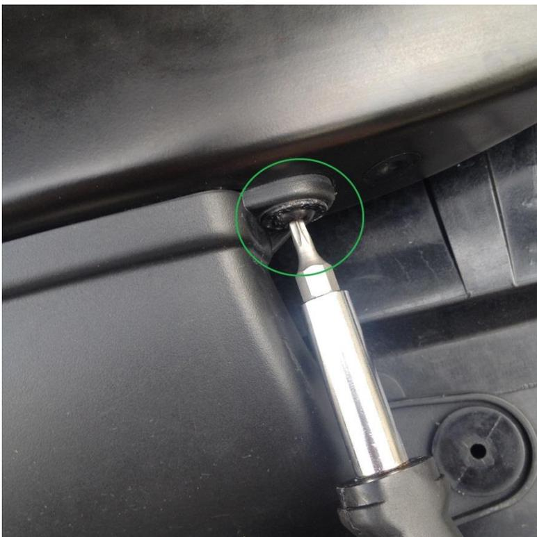
2. Torx-Schrauben an der Ansaughaube lösen und die Ansaughaube entfernen.
